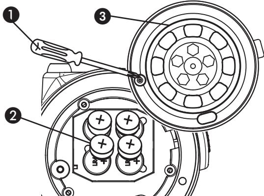
**Merk:** For å fjerne batteriene må du sette inn en skrutrekker (eller lignende) i det lille mellomrommet på siden av batteriet og vippe batteriet forsiktig ut av batteriområdet.
