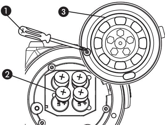
**OBS:** För att ta ur batterierna, sätt i en skruvmejsel (eller liknande verktyg) i försänkningsområdet för varje batteri och lyft försiktigt ut batteriet från facket.
