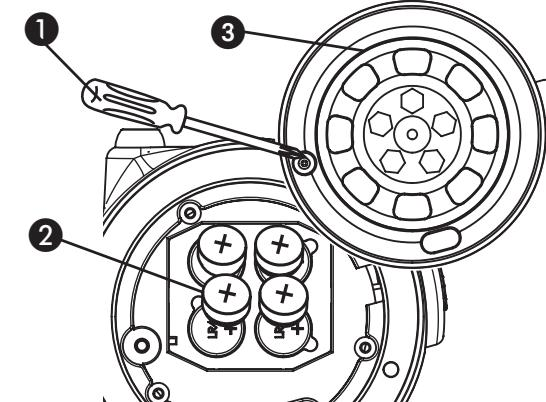
**Remarque :** Pour retirer une pile, insérez un tournevis (ou un outil similaire) à côté de l'extrémité de la pile et la soulever doucement pour la sortir du compartiment à piles.
