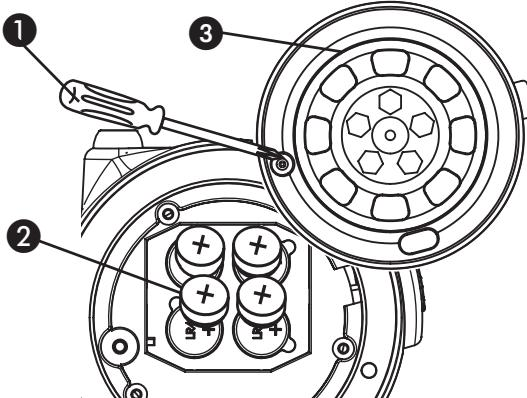
**Nota:** Para remover as pilhas, inserir uma chave de fendas (ou uma ferramenta similar) na parte rebaixada de cada pilha e levantar suavemente a bateria do respetivo compartimento.
