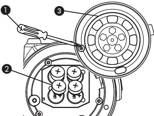
**Nota:** Per rimuovere le batterie, inserire un cacciavite (o un utensile simile) nell'area incassata di ogni vano batteria e sollevare delicatamente la batteria dal vano.
