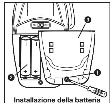
Installazione della batteria
