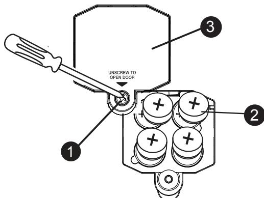
**Merk:** For å fjerne batteriene må du sette inn en skrutrekker (eller lignende) i det lille mellomrommet på siden av batteriet og vippe batteriet forsiktig ut av batteriommet.
