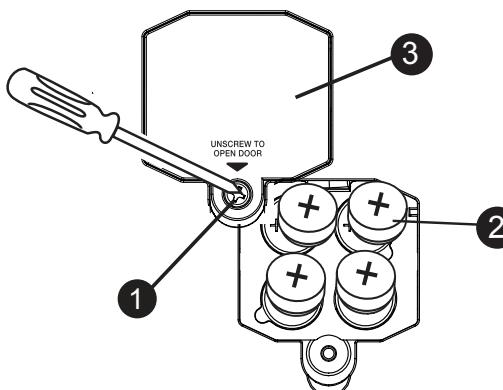
**OBS:** För att ta ur batterierna, sätt i en skruvmejsel (eller liknande verktyg) i försänkningsområdet för varje batteri och lyft försiktigt ut batteriet från facket.
