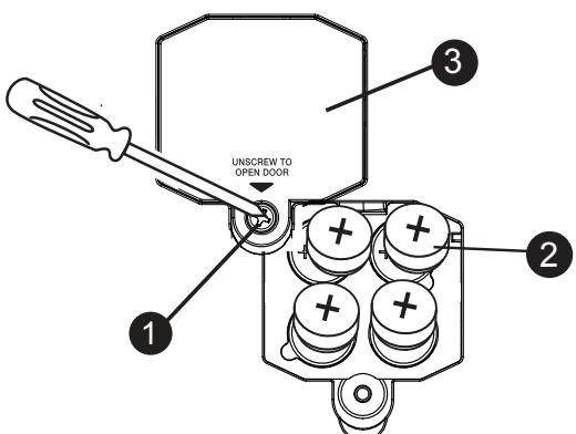
**Hinweis:** Um die Batterien zu entfernen, positionieren Sie einen Schraubenzieher (oder ein ähnliches Werkzeug) in der Vertiefung der jeweiligen Batteriemulde und heben Sie die Batterie dann vorsichtig an.
