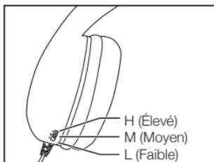
Le commutateur de volume est situé à l'intérieur de l'oreillette gauche. Avant d'utiliser votre casque, demandez à un adulte de positionner le commutateur de volume sur un niveau approprié (Élevé, Moyen ou Faible) en se servant de la pointe d'un stylo, d'un trombone ou autre objet similaire.
