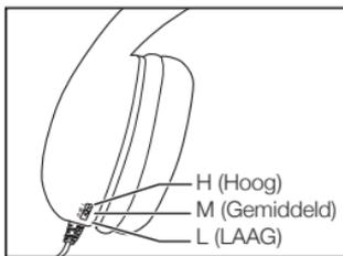
De volumeregelaar bevindt zich aan de binnenkant van de linker oorschelp. Laat voor gebruik een volwassene de schakelaar verschuiven door middel van een potlood, paperclip of ander klein hulpmiddel om het volume van de hoofdtelefoon in te stellen op Hoog, Gemiddeld of Laag.
