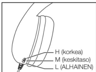
Äänenvoimakkuuden säädin sijaitsee vasemman korvakupin sisäpuolella. Anna ennen käyttöä aikuisen asettaa kuulokkeiden äänenvoimakkuus korkeaan, keskitasoon tai alhaiseen kynällä, paperiliittimellä tai muulla pienellä esineellä.
