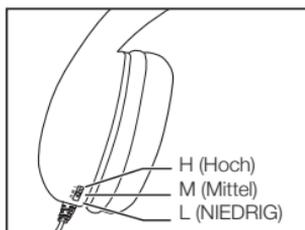
Der Lautstärkeschalter befindet sich auf der Innenseite der linken Hörmuschel. Stellen Sie den Schalter der Kopfhörerlautstärke als Erwachsener mit einer Büroklammer, einem spitzen Bleistift oder einem kleinen Werkzeug auf H (hoch), M (mittel) oder L (niedrig).
