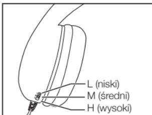
Przełącznik głośności znajduje się z boku lewej muszli słuchawkowej. Przed użyciem dorosły przesuwa przełącznik ustawiający głośność słuchawek na poziom wysoki, średni lub niski.
